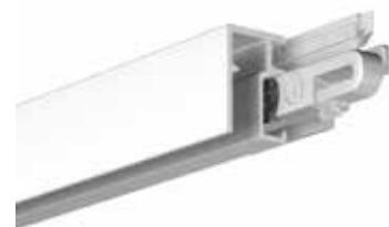
Le rail R10 est extrudé dans un aluminium de première qualité - il supporte un poids de 20kg par mètre linéaire (dim : 17 x 12mm)
