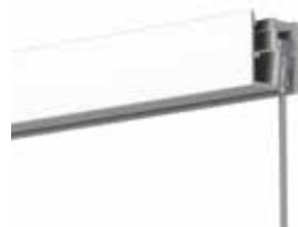
Le rail R40 est la seule cimaise au monde à se fixer au plafond au moyen de clips invisibles. Il peut s'installer en tous points du plafond et est particulièrement adapté aux vitrines des magasins. Le R40 est extrudé dans un aluminium de première qualité et supporte jusqu'à 20kg par mètre linéaire (dim : 18.3 x 17.6 mm).
