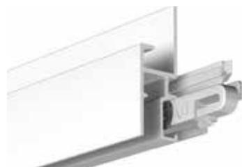
Le R30 est un rail professionnel destiné aux galeries et musées. Il est extrudé dans un aluminium de première qualité et supporte jusqu'à 50kg par mètre linéaire (dim : 34,8 x 11,5 mm).
